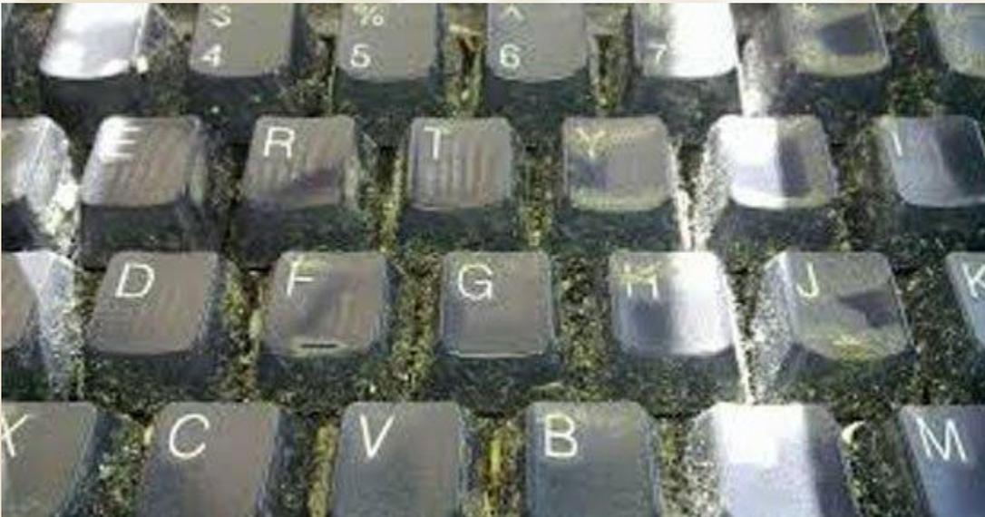
Antes de retirar las teclas ten la certeza de que sabrás volverlas a poner en su lugar correcto después de la limpieza. Para eso usa tu imaginación, toma una foto del teclado o haz un dibujo con la posición de las teclas.
